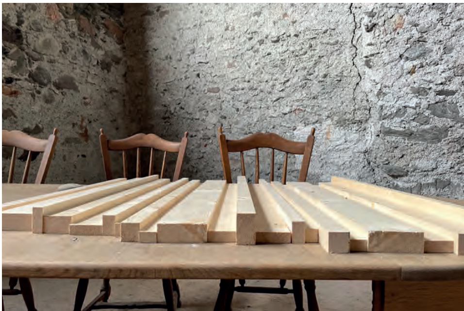
Musterleisten Fichte für die Deckenverkleidung 19.08.2022
